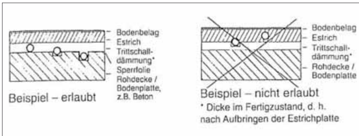
Bild 3.7 : Verlegungsbeispiele
